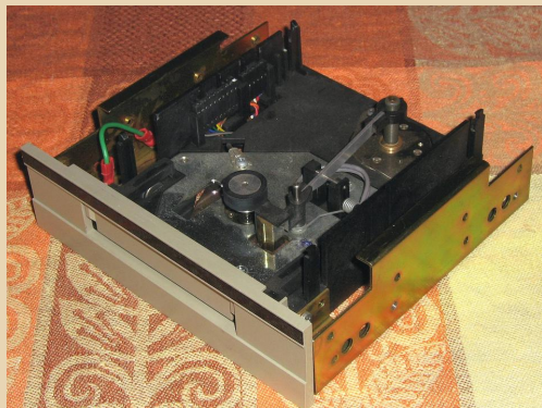
Вертикальное смещение блока магнитных головок, подвижно посаженного на шпенёк,
